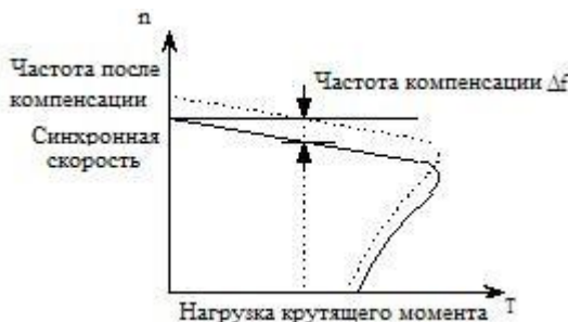
Рисунок 5.9.4 График автоматической компенсации скольжения
