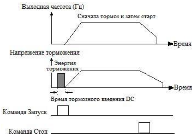
Рисунок 5.1.1 Сначала торможение и затем запуск
