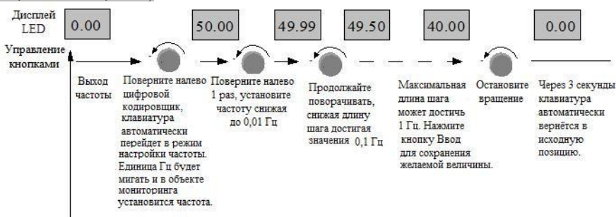
Рисунок 3.4 Блок-схема настройки частоты
