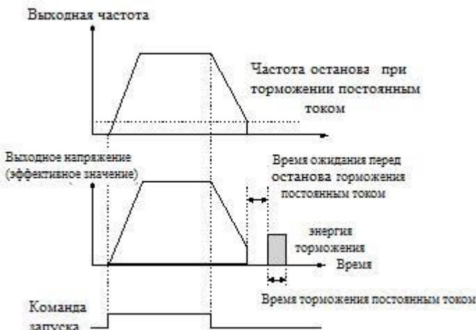
Рисунок 5.1.7 Торможение постоянным током
