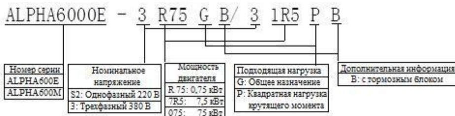
Рисунок 1.1 Расшифровка кода модели
