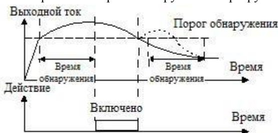
Рисунок 5.13.2 Функция предварительной сигнализации перегрузки.
