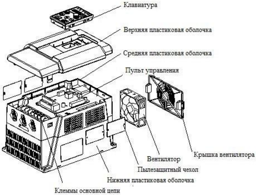
Рисунок 2.4 Основные части 5,5 кВт – 7,5 кВт
