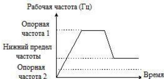
Рисунок 5.2.3 Работа на нижней предельной частоте
