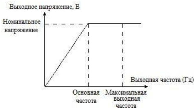
Рисунок 5.0.1 Зависимость между выходной частотой и выходным напряжением.
