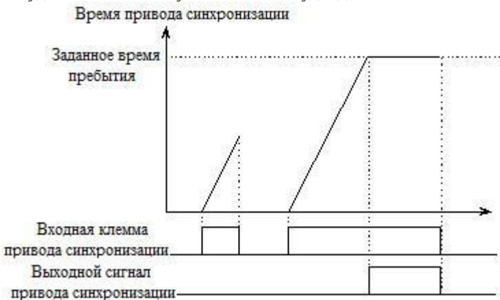
Рисунок 5.3.7 Вход привода синхронизации
