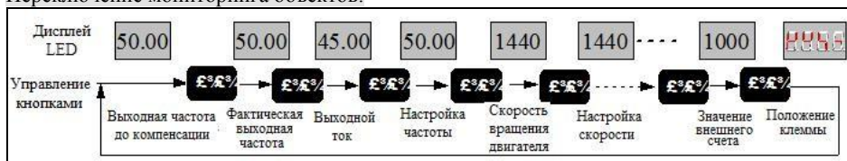
Рисунок 3.3 Операция отображения параметров в состоянии «Запуск/остановка»
