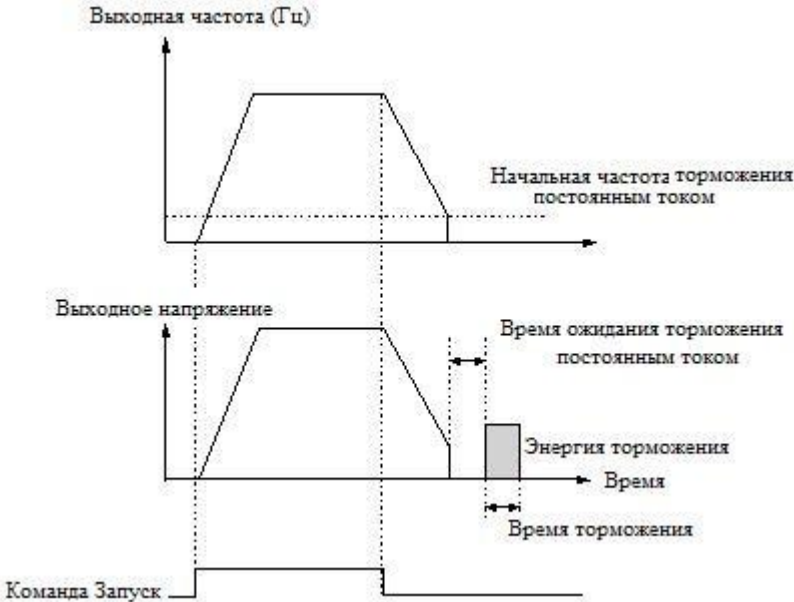
Рисунок 5.3.5 Торможение постоянным током
