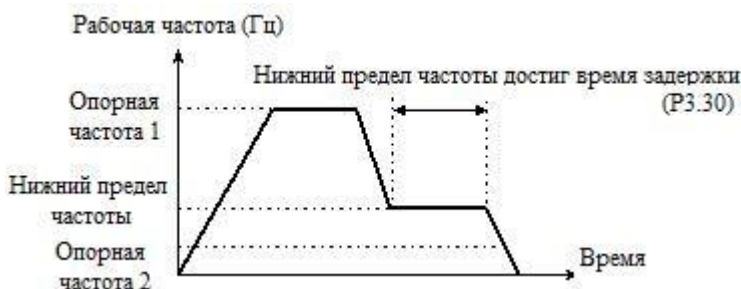
Рисунок 5.2.4 Работа на нулевой частоте
