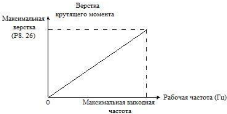
Рисунок 5.8.2 Связь между высокоскоростным дополнением крутящего момента и выходной частотой
